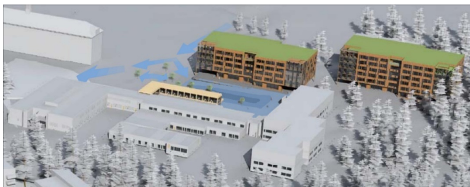
Figur 10. Vattendelare för att förhindra översvämning av instängd yta.
