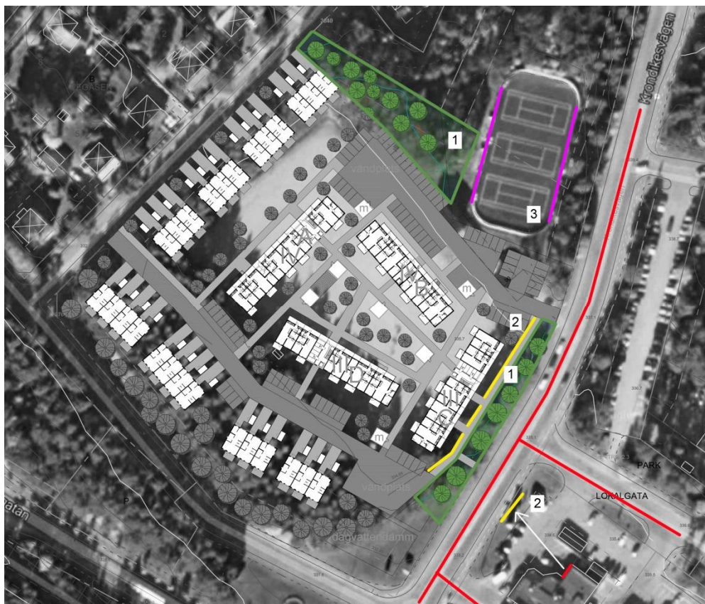
Figur 21, Visar rekommenderade åtgärder för att eliminera ljusstörningen. Förklaring - 1. Buskage/träd. 2. Staket. 3. Anpassad hockeyrinkbelysning.
