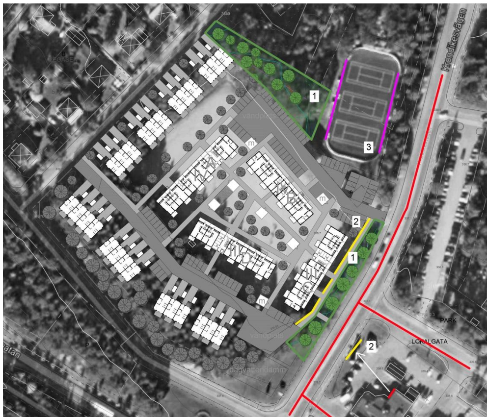
Figur 1, Visar rekommenderade åtgärder för att eliminera ljusstörningen. Förklaring - 1. Buskage/träd. 2. Staket. 3. Anpassad hockeyrinkbelysning.
