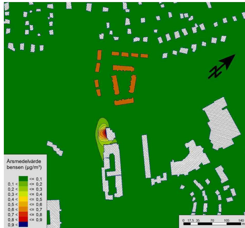
Figur 6 Beräknat årsmedelvärde av bensen från bensinstation ( \mu\text{g}/\text{m}^3 ). De nya husen visas med brun färg. Miljö kvalitetsnormen för bensen är 5 \mu\text{g}/\text{m}^3 och luktröskeln är 1200 \mu\text{g}/\text{m}^3 .
