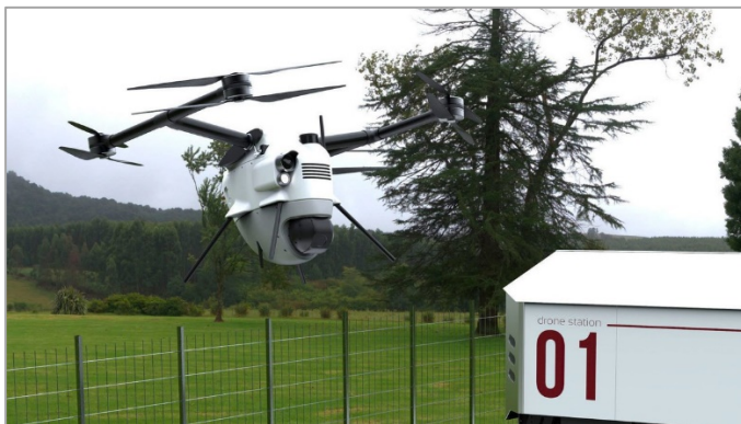
Figur 18 - Sevendof utvikler i samarbeid med flere energiselskaper et autonomt system for overvåking og feilsøking av kraftlinjer (Foto: Sevendof)
