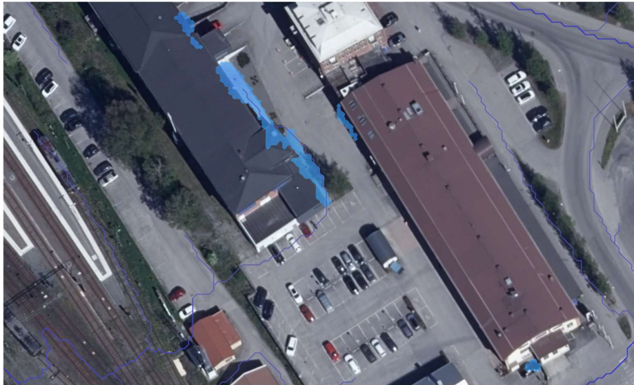
Lågpunkt med eventuell vattensamling vid skyfall.
