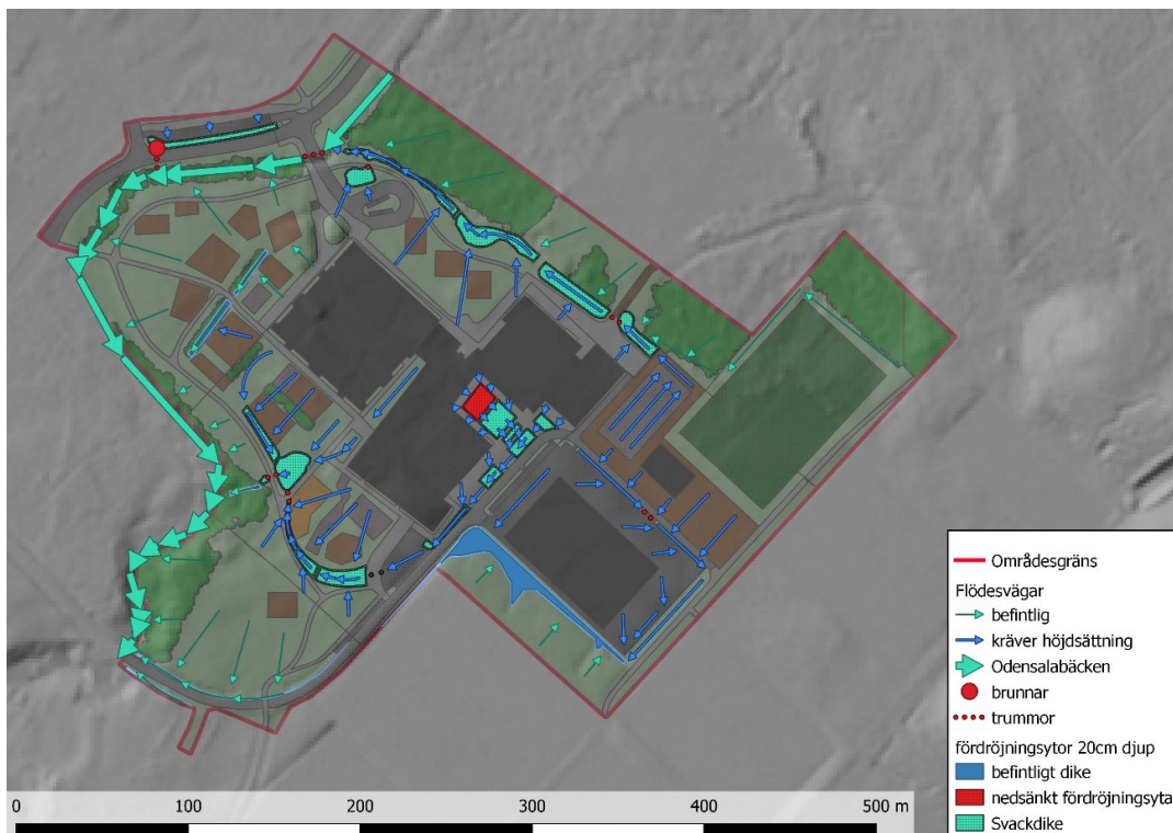
Översiktlig illustration över riktningar i dagvattenflödena och dess omhändertagande.
