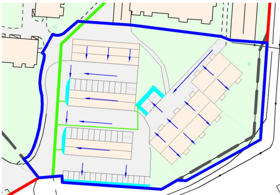
Förslag på åtgärder vid den södra parkeringsytan. Turkosa ytor illustrerar infiltrationsstråk/växtbäddar. Blåa pilar visar antagna flödesriktningar. Den större gröna linjen visar antagen befintlig ledning, tunnare gröna linjer är föreslagna anslutningar till befintlig ledning.
