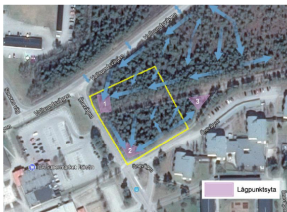
Befintlig avvattnings av området med lågpunktsytor.
