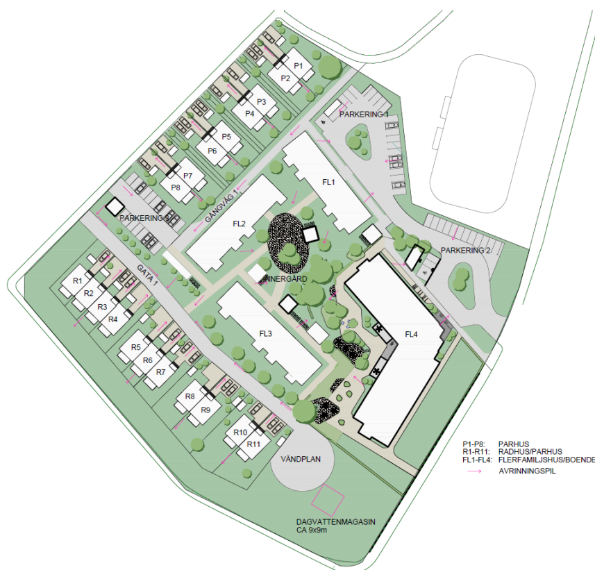
Illustration av dagvattenåtgärder för trög ytavrinning samt ungefärlig placering av dagvattenmagasin, källa PM dagvatten, Arctan.
