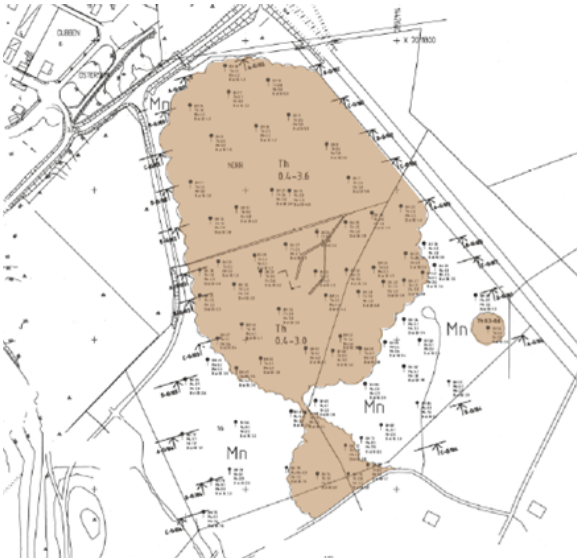
Figur 11: Karta från geoteknisk utredning.
