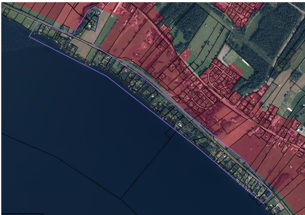
Figur 9. Kartlager med huvudbyggnader. Klustergräns visas med lila polygon. Befintligt verksamhetsområde för dricksvatten och avlopp visas med rödfyllt polygon.
