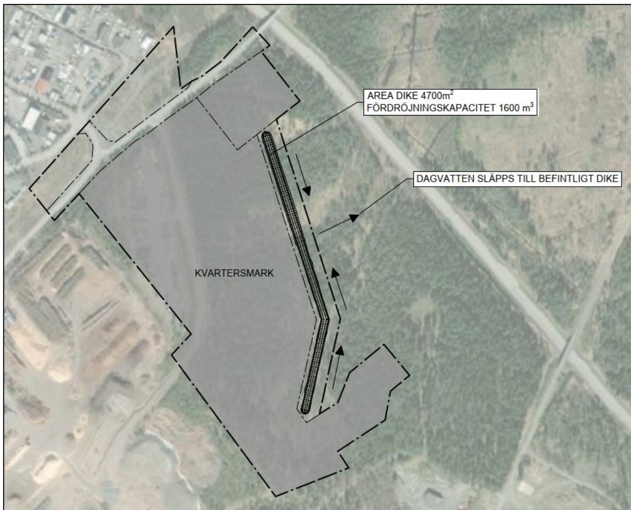
Figur 23. Föreslagen placering av makadamdiket inom allmän platsmark. Dagvattnet föreslås släppas med ett strypt flöde till det befintliga diket vilket illustreras i figuren
