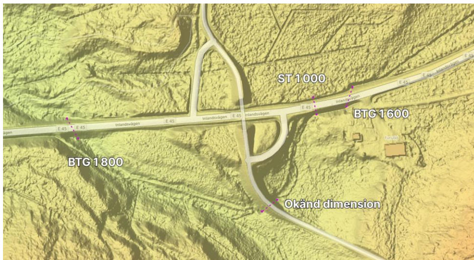
Figur 2. Vägtrummor under E45. Trumma med okänd dimension har antagits vara 800 mm.
