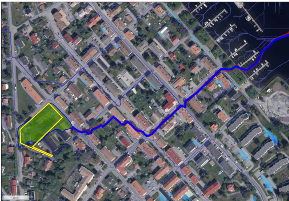
Figur 15 Nuvarande flödesvägar och lågpunkter vid 37 mm regn inom och runt området, baserat på nationella höjdmodellen. Grönmarkerat område visar avrinningsområdet som belastar planområdet (Scalgo Live, 2025)
