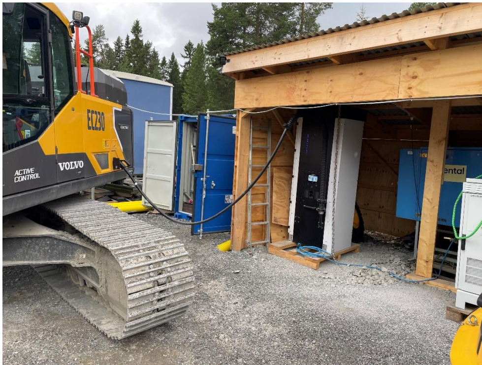
Figur 7: Den elektriska grävmaskinen Volvo EC230 Electric laddar på arbetsplatsen. Foto: Skanska
