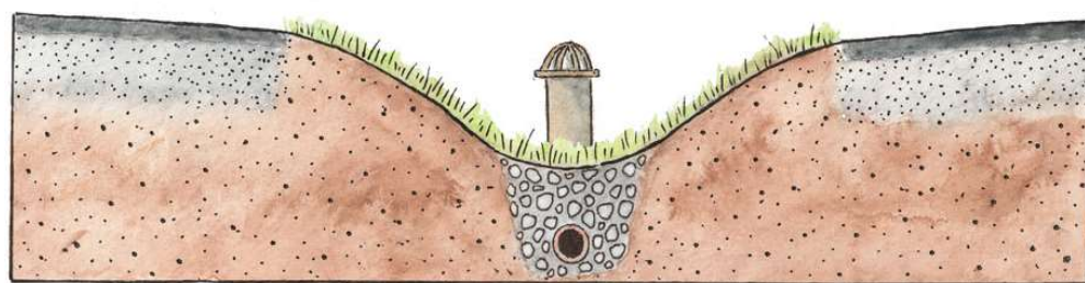
Figur 11. Principiell figur över hur ett makadamdike kan utformas med vegetation. Bild tagen från VA-guiden, 2024
