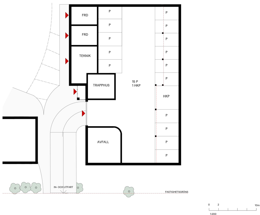
Figur 9: Garageplan med p-platser och förslag på planlösning i souterräng med infart från Kaptensgatan.
