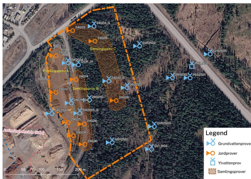
Figur 12. Diskreta provtagningspunkter (skruvpunkter), ytor för samlingsprover och lägen för grundvattenrör. Gräns mellan morän i västra delen av undersökningsområdet och torv i östra delen av undersökningsområdet går vid grusvägen som löper från norr till söder i bilden.
