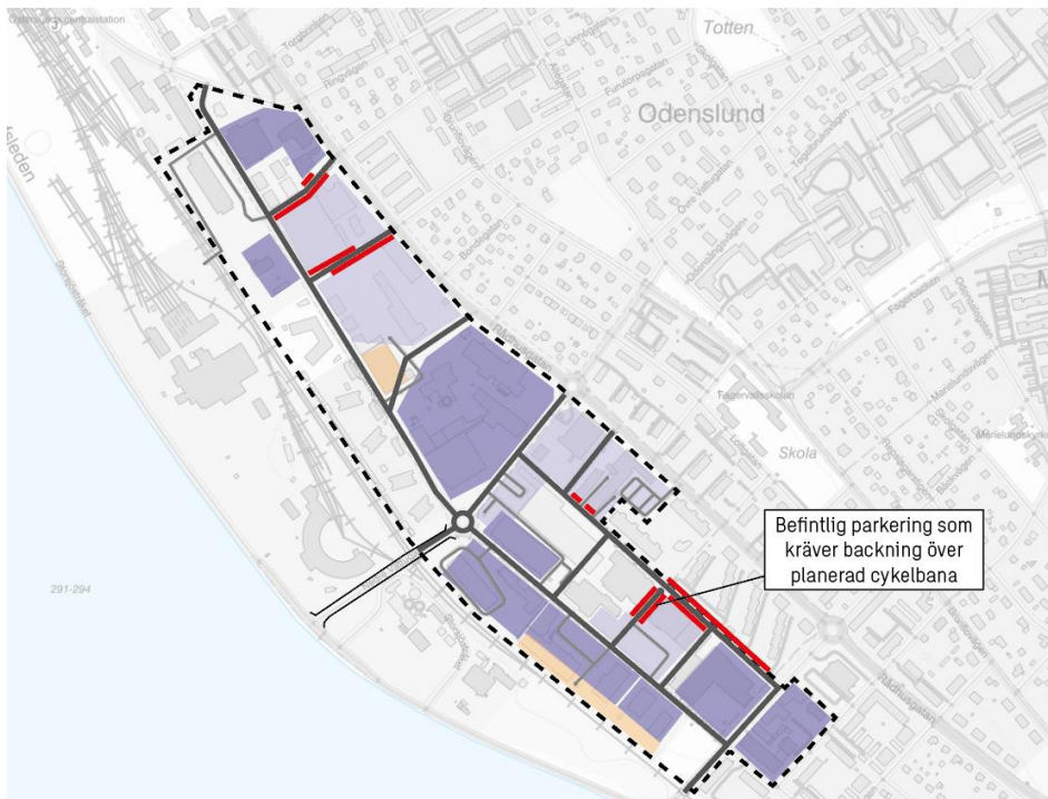
Figur 51. Översikt över sträckor (röd linje) där parkering finns på kvartersmark som kräver backning över gångytor vilket föreslås tas bort för att öka säkerheten för oskyddade trafikanter.
