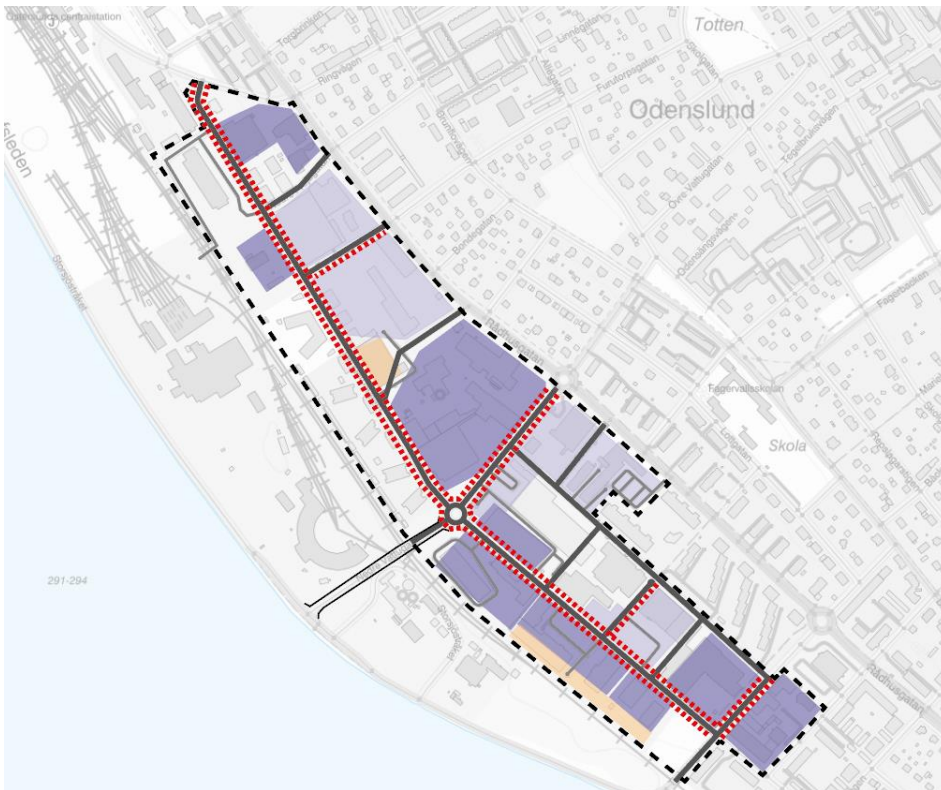
Figur 52. Översikt över sträckor där in- och utfart från garage ej bör placeras (röd streckad linje).
