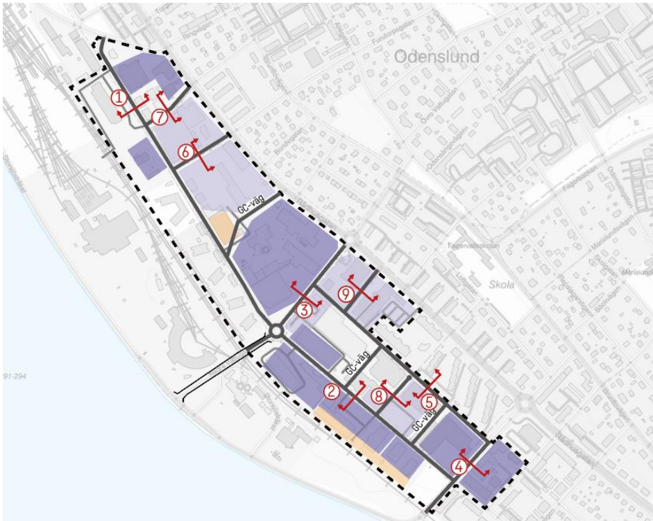
Figur 38. Översikt över förslag på nya sektioner för gator inom planområdet
